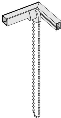
Das Verfahren des Behanges erfolgt über eine Kugelschleife Ø 6 mm.
