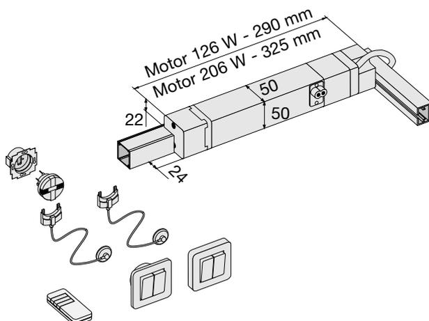
Der in der Kopfschiene integrierte Motor steht in zwei Stärken zur Verfügung (siehe Tabelle).
