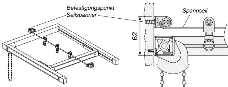
Bedingt durch die hohen Zugkräfte am Spannseil auf geeignete Befestigungspunkte achten.
