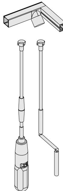
Der Winkelantrieb kann wahlweise mit einer Handkurbel oder einem Akku-Stab bedient werden.
