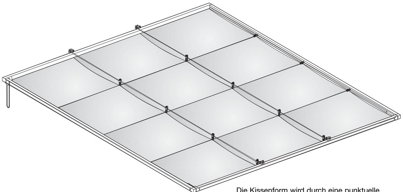
Die Kissenform wird durch eine punktuelle Aufhängung am aufgenähten Schlaufenband erreicht.
