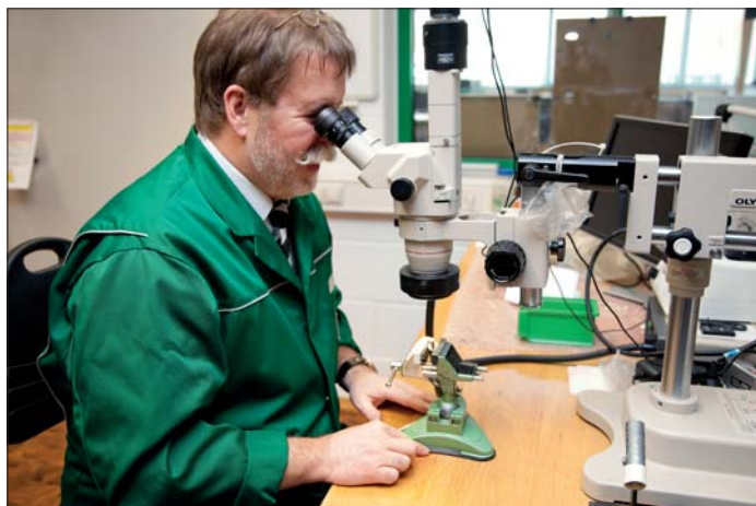
Mikroskopická kontrola vstřikovací trysky dieselového motoru po provedené zkoušce.
