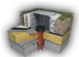
Obr. 6 – Kontrolní šachta pro zelené střechy
