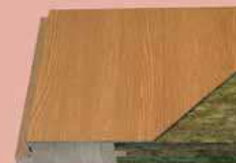
dveřní výplň dutinková protipožární dřevotříská
