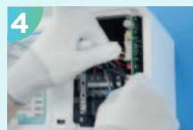
Odpojte kabelové konektory
