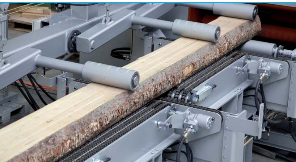
Abb. 1: Mit der halbautomatischen Beschickung SAB werden schwere Werkstücke sicher transportiert.
