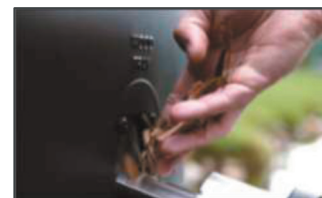
Patentovaný systém bočního plnění dřevní štěpky
