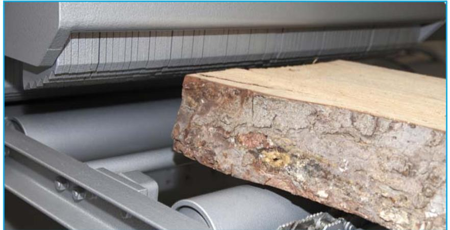
Abb. 9: Rückschlagsicherung für mehr Sicherheit
