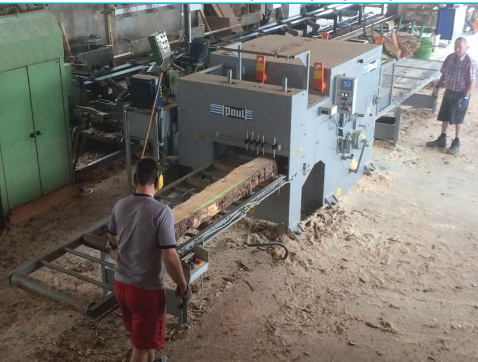
Die Maschinen der Modellreihe S sind für den extremen Einsatz gebaut: Robust, schwer und kraftvoll. Drei Grundmodelle mit maximalen Durchgangsbreiten von 906, 1206 und 1506 mm bieten für jeden Anwendungsfall die passende Arbeitsbreite.
