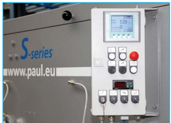
Abb. 20: MAXIRIP Bedienterminal mit Touchpanel und Joystick
