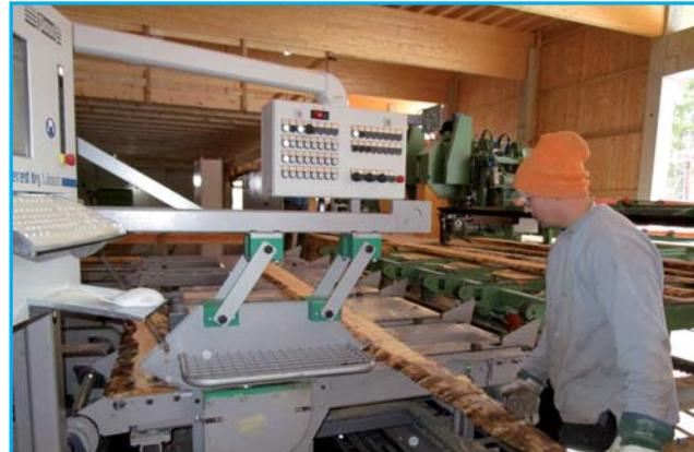
Abb. 11: Durchlaufkappsäge
