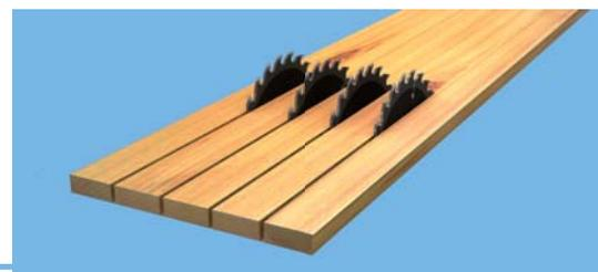
**Abb. 25:** Auftrennen besäumter Brettware in der Auftrennkreissäge
