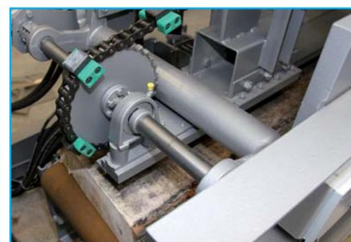
Abb. 8: Die Walzen unten und die angetriebene Kette oben sorgen für einen exakten Transport in die Kreissäge
