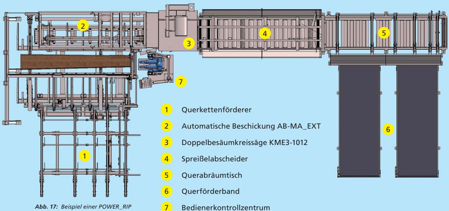
Abb. 17: Beispiel einer POWER\_RIP mit AB-MA\_EXT
