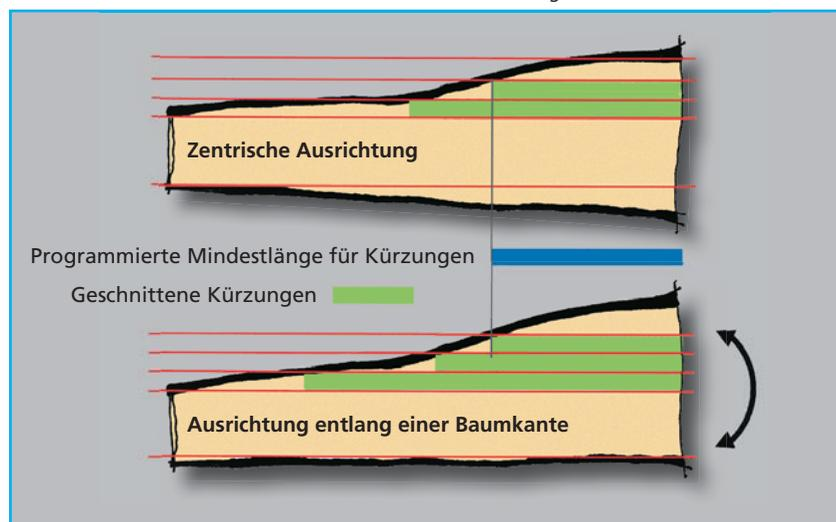
Abb. 7: Es gibt zwei Ausrichtverfahren für automatische Beschickungen
