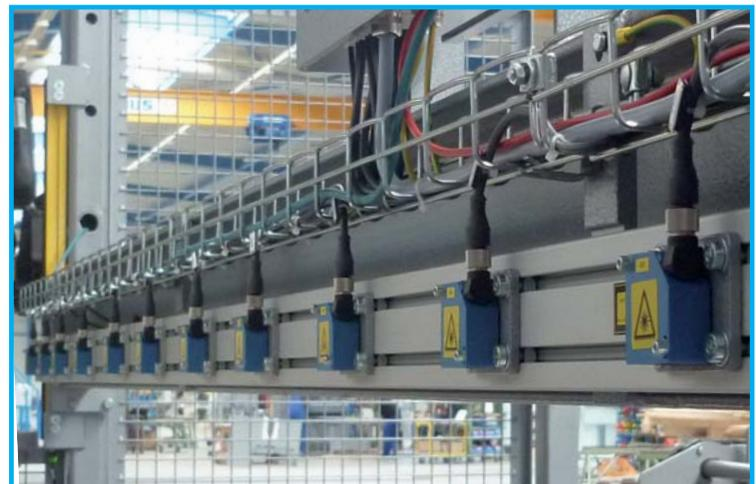
Abb. 4: Die Messköpfe der vollautomatischen Beschickung AB920
