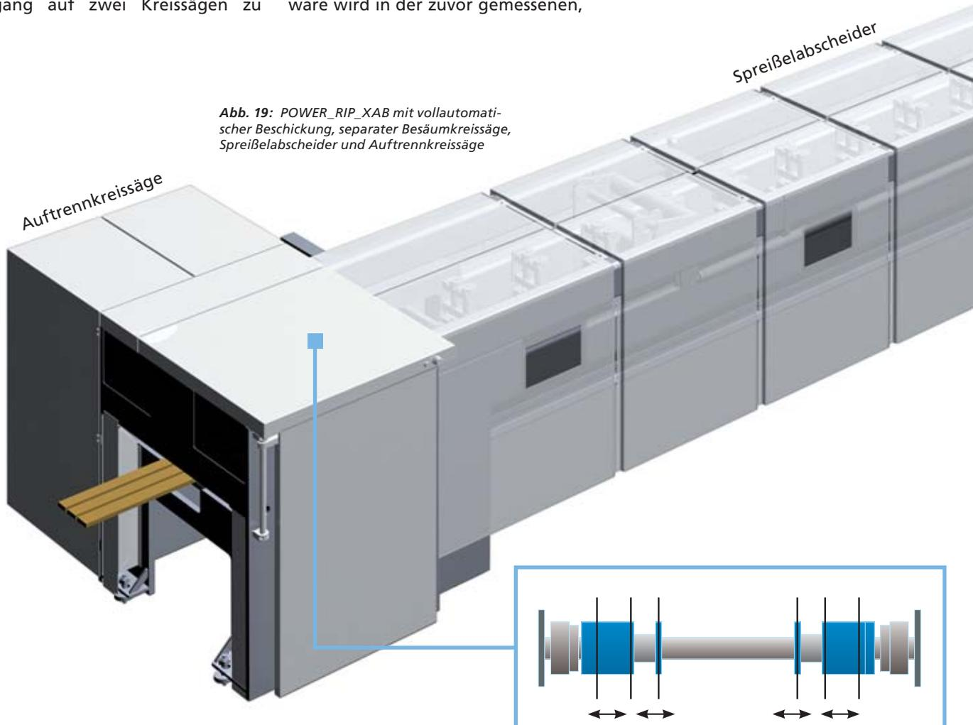
**Abb. 19:** POWER\_RIP\_XAB mit vollautomatischer Beschickung, separater Besäumkreissäge, Spreißelabscheider und Auftrennkreissäge
