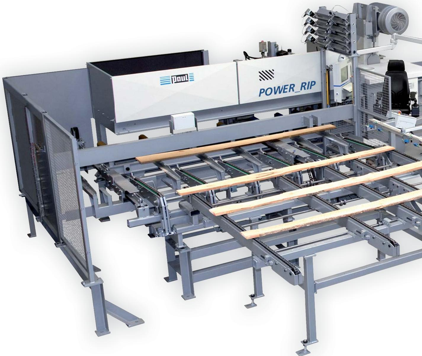
Doppelbesäum-, Nachschnitt- und Auftrennkreissägen erreichen maximale Leistung und Ausbeute durch optimale Beurteilung, Ausrichtung und Einteilung der Werkstücke. Beschickungssysteme von Paul unterstützen den Bediener bei diesen Aufgaben und machen damit seine Arbeit einfacher, effizienter und sicherer.
