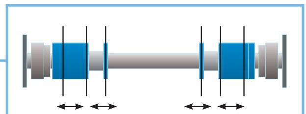
**Abb. 20:** Sägewelle mit bis zu vier verstellbaren Teleskop-Sägebüchsen
