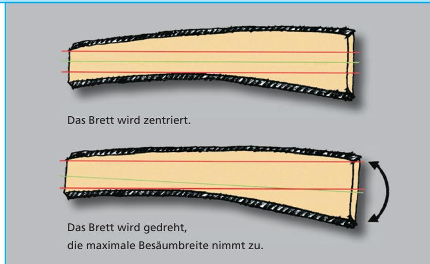
Abb. 6: Werkstücke werden nicht einfach zentriert sondern gedreht
