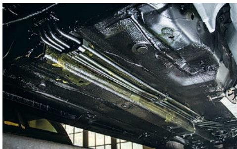
KRITICKÝ drobnýhled pracovníků STK se zaměřuje také na stav brzdového potrubí. Oprávněně!
