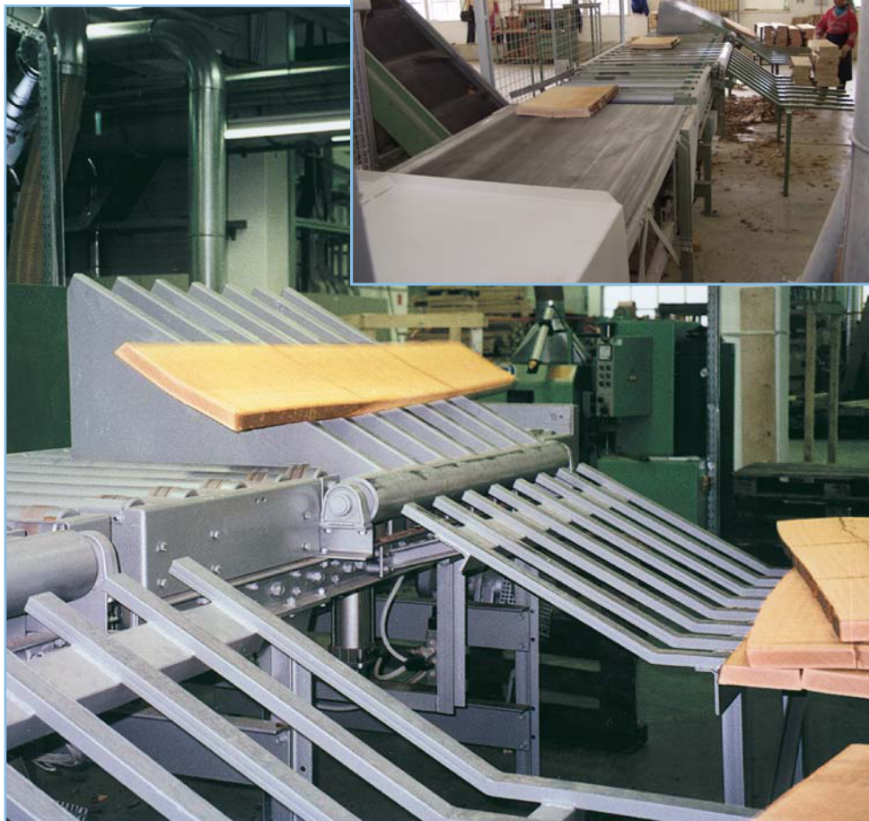
Abb. 11 Automatischer Abwurf von Fixlängen an der gewünschten Sortierstation
