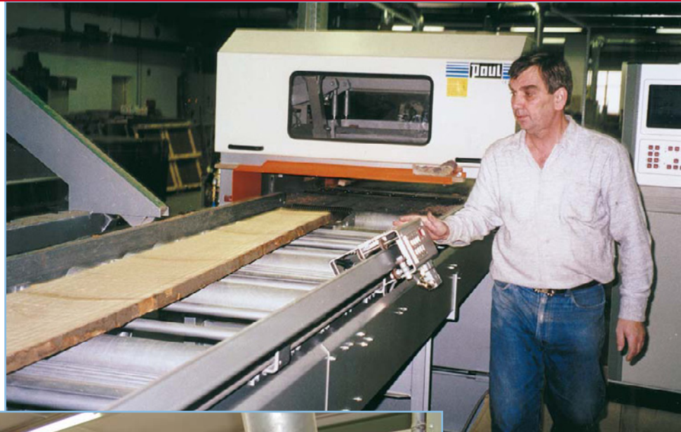
Abb. 6 Verfahrbarer Messwagen zur berührungslosen Schnittstellen- und Fehlermarkierung
