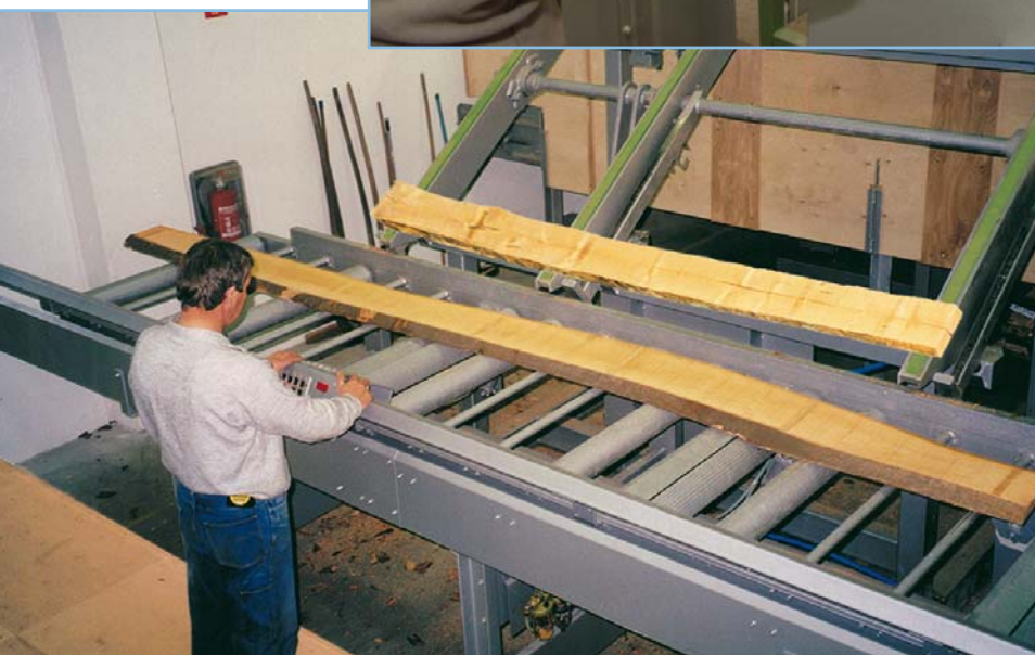
Abb. 8 Berührungsloses Markieren mit Laser und Funktionstasten
