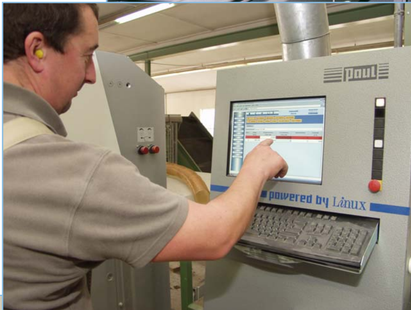
Abb. 7 Moderne CNC-Steuerung mit Touchscreen
