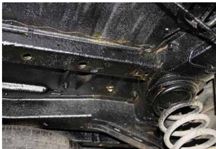
Podlaha patří ke kritickým místům mnoha starších, zejména japonských automobilů. Není od věci s preventivními nátěry začít už po třech letech.
