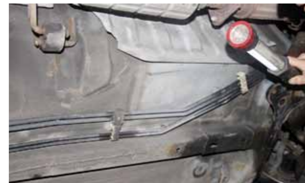
Tovární ochranný nátěr chrání podlahu Mazdy 6 jen na některých místech
