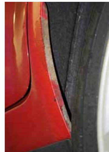
Rezavějící lem je třeba vyměnit, natření pomůže jen na cestu do bazaru
