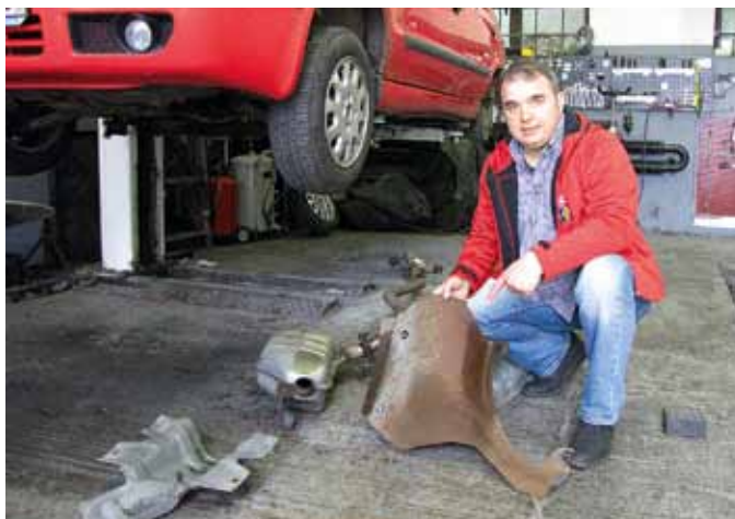
Teprve demontáž výfuku odhalila, že kryty pod ním už také rezaví. Když se na to přijde včas, dají se zachránit.
