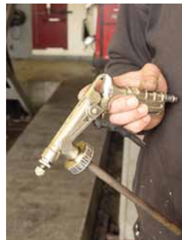
Na spreje z autokosmetiky zapomeňte. Nutným základem je ruční tlaková pistole.
