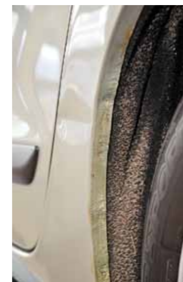
Rezavějící lem je třeba vyměnit, natření pomůže jen na cestu do bazaru
