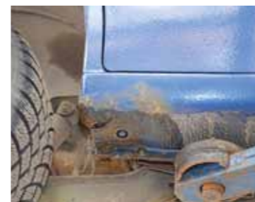
Hrany prahů představují technologicky složitá body, navíc vystavené vnějším vlivům
