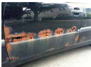
Plastové lišty zabráni škrábancům, drží však pod sebou vlhkost. Pravidelně kontrolujte.
