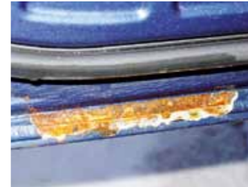
Pro schopnost odolávat korozi je rozhodující kvalita svařování i laku
