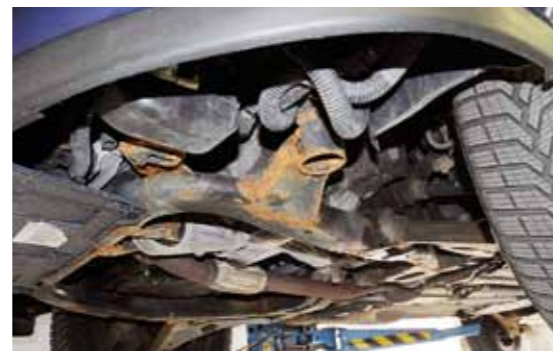
Pětiletý Opel Astra: Vůz z operativního leasingu jezdil do značkového servisu. Obáváme se, že tady už je na záchranu rámu pozdě.
