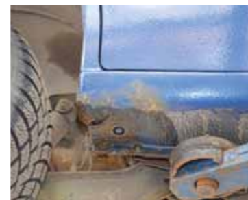
Hrany prahů představují technologicky složitá body, navíc vystavené vnějším vlivům
