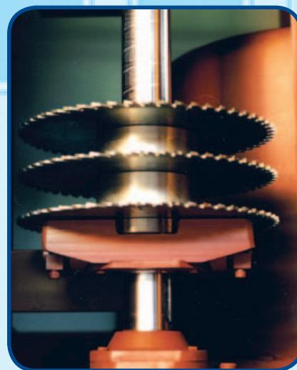
Abb.2: verstellbare Sägebüchse mit aufgespannten Sägeblättern (Draufsicht)
