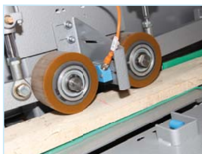
Abb. 9 Separate Messstation erkennt die Positionen der Kreidemarkierungen
