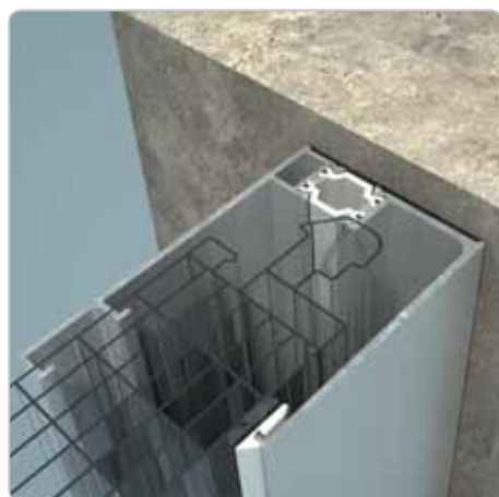
BOČNÍ PROFIL Detail strany ALU profilu s tepelní brzdou
