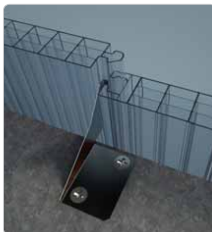
Vložení nerezové spojky Vložení nerezové spojky ke spojení s podpůrnou konstrukcí (s vlastní stavbou).
