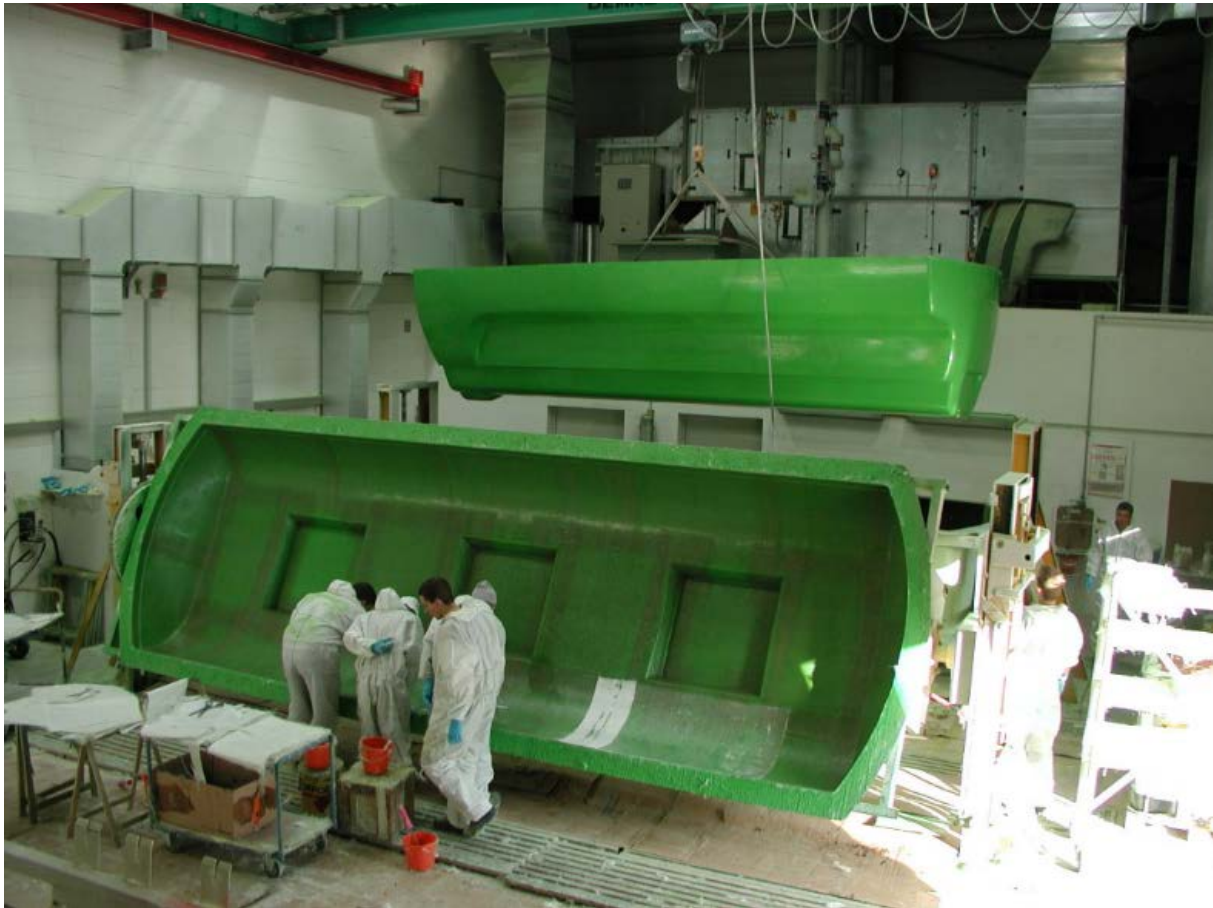
Obr. 7 Ukázka procesu ručního laminování
