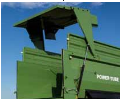
Obr. 3 Hydraulické uzavírání zadního čela v provedení s dvojčinnými pístnicemi
