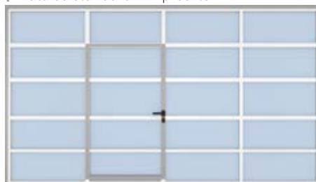
| Vrata se standardním prosklením a integrovanými dveřmi
